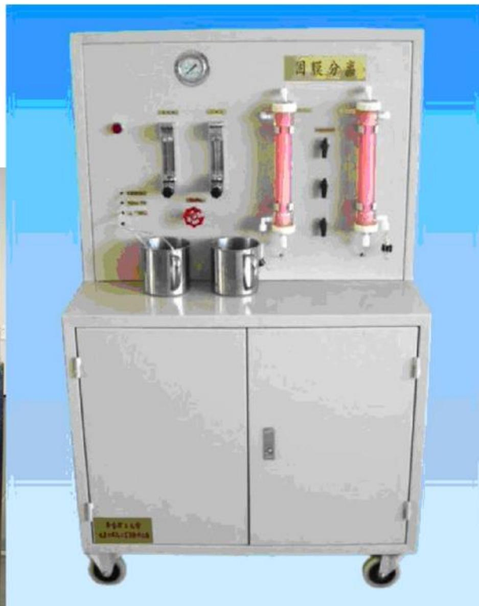
中空纤维超滤膜实验设备
