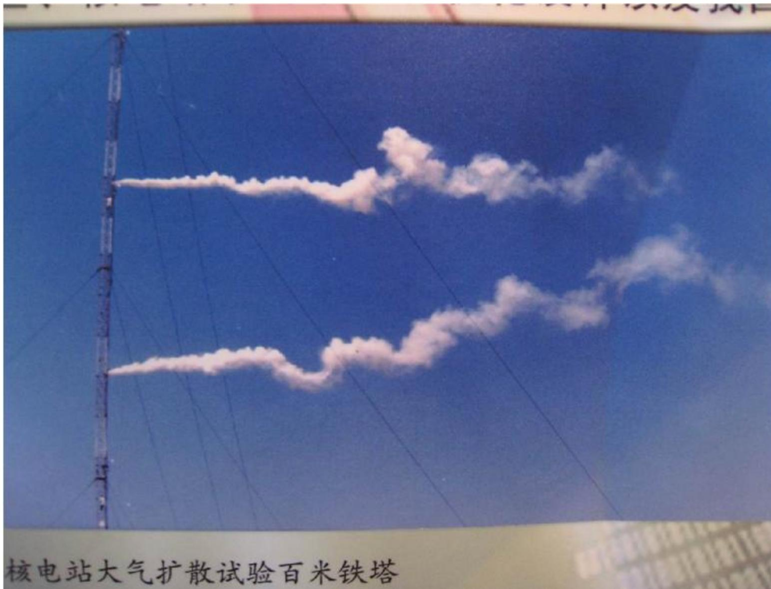
核电站大气扩散试验百米铁塔
